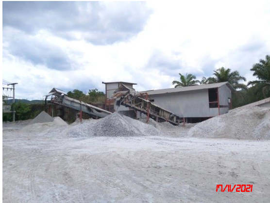
อาคารปิดคลุมโรงไหมหิน 3 ด้าน
